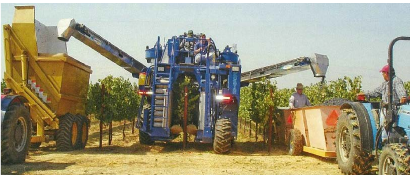
Figuur 1: Aangepaste oesmasjiene met twee geute om verskillende sones, met verskillende druifgehalteklasse soos deur NDVI beelde geïdentifiseer is, in verskillende parsbakke te oes. (Kurtural et al., 2011)
