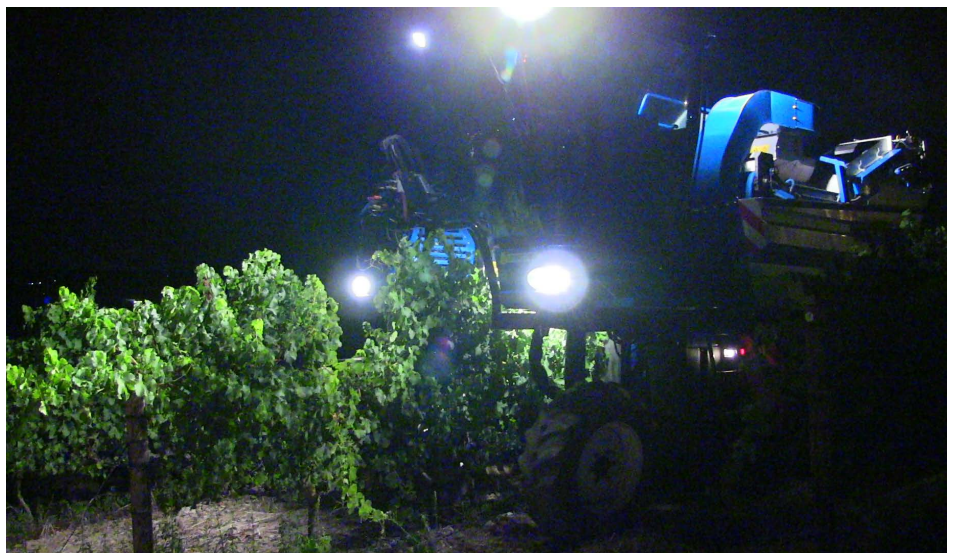
Figuur 1: Meganiese oes in die nag om fenoliese oksidasie te voorkom en die temperatuur van die geoeste druiwe laag te hou. (Foto: Robert Stolk)
