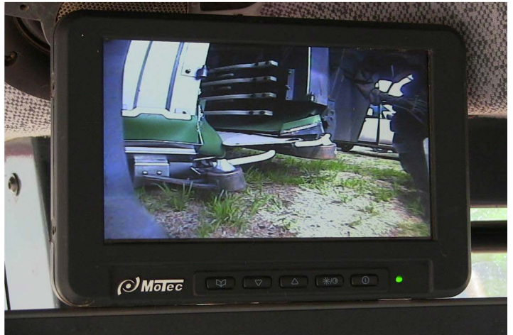
Figuur 4: Elektroniese beheerpaneel (bo) en skerm met beeld van kamera wat die grond volg (onder). (Foto: Robert Stolk)
