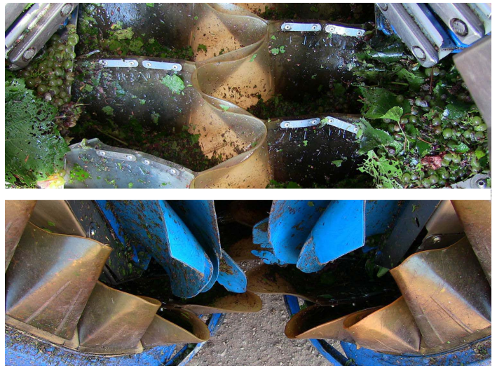
Figuur 3: Meganiese oesmasjien wat met opvangbakkies (bo) werk. Hierdie bakkies dien dan verder ook as dubbele vervoerbande (onder) wat die duiwe na die parsbakke op die masjien vervoer. (Foto: Robert Stolk)
